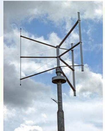
Éolienne à axe vertical installée sur le site de l'entreprise Nonet-Hublet
