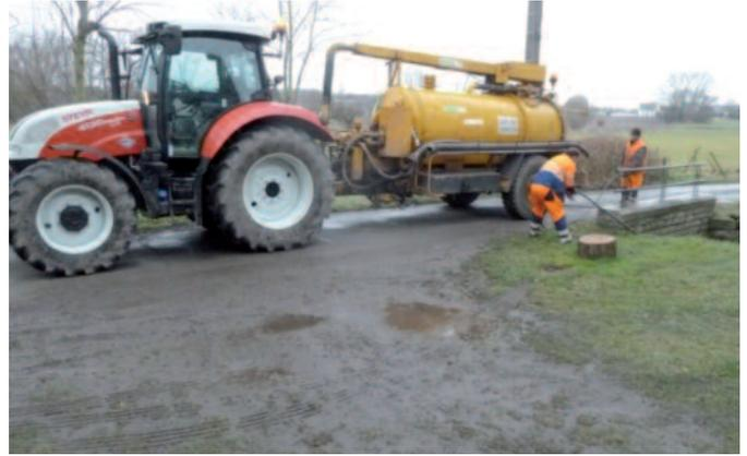
Depuis quelques mois, un nouveau tracteur est venu renforcer notre flotte de véhicules. Il s'agit d'un Steyr 4130 Proli 150 ch à transmission et à variation continue. Il remplace un ancien Deutz et sert en voirie pour tracter hydrocuveuse, bennes et porte container.
